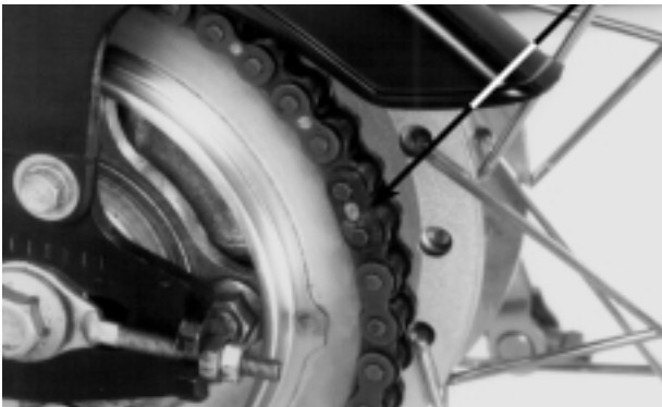
CORRENTE DE TRANSMISSÃO PRESILHA DE RETENÇÃO
